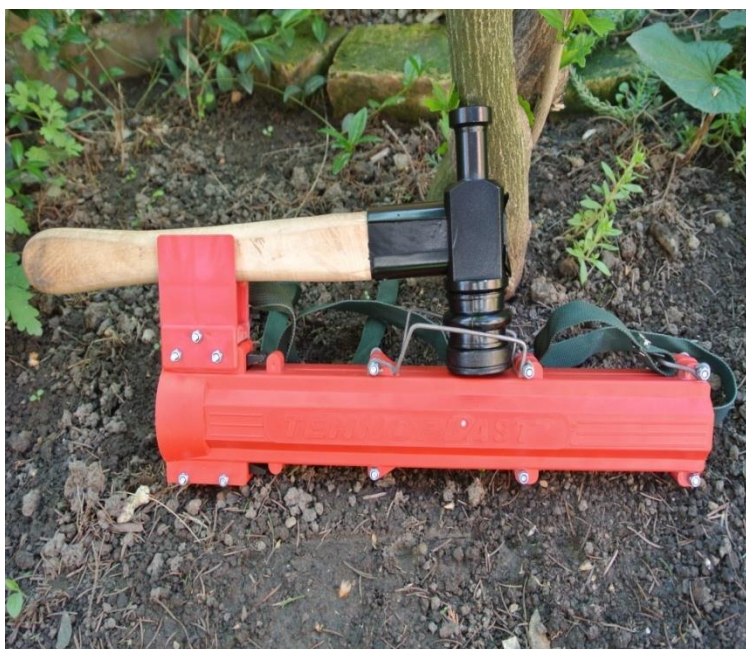
Slika 1. čekić za utiskivanje pločica i magacin za pločice
